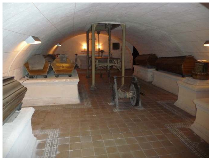
Pohľad na funkčný mechanizmus, ktorým sa spúšťajú rakvy do hrobky Clamovcov-Gallasovcov v kláštornom Kostole Navštívenia Panny Márie v Hejniciach.
